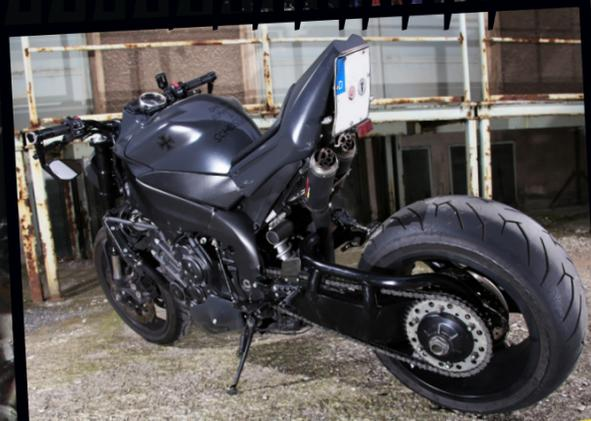
**R1 mit verlängerter maßgefertigter Einarmschwinge und 240er Socken. Kompletter Umbau by Strassenmeister**
